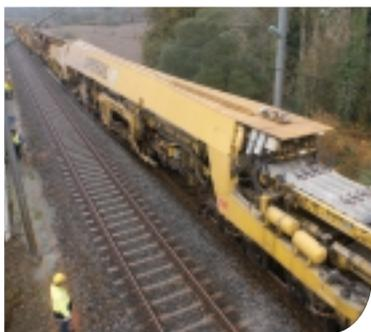
Cette opération consiste à retirer le ballast de la voie. La dégarnisseuse soulève la voie et extrait le ballast qui est trié. La partie récupérable est immédiatement déposée sur la voie, le reste est chargé sur la machine. Un train de ballast neuf et une bourreuse remettent la voie à niveau pour la rendre accessible à la circulation des trains de travaux suivants.
