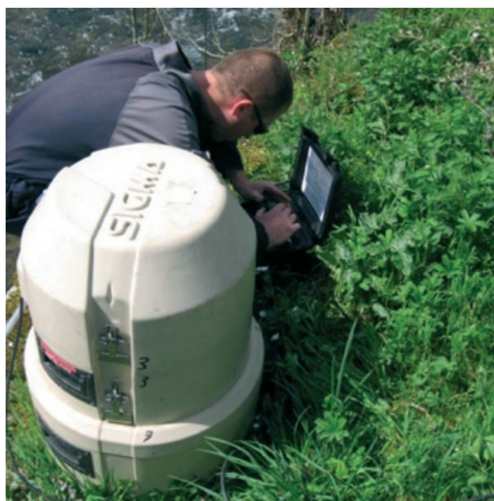
Relevé du niveau d'eau souterraine
